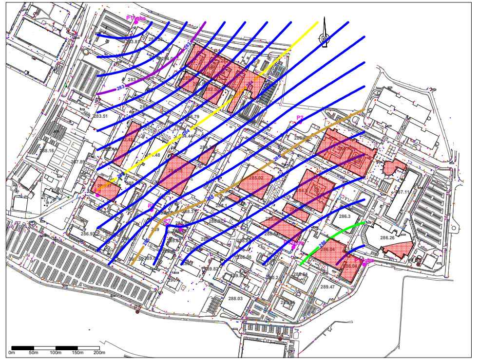
Mittelwasser April 2011 (mit Wasserhaltung)
